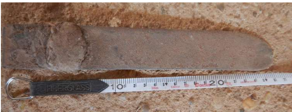
Lâmina C, com sinal de terra e uso intenso (ambos lados)
