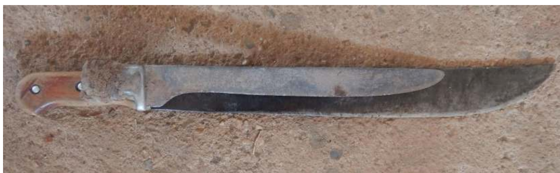
Sobreposição do instrumento E sobre lâmina de mesmo porte, quando entregue, para observação de seu desgaste
